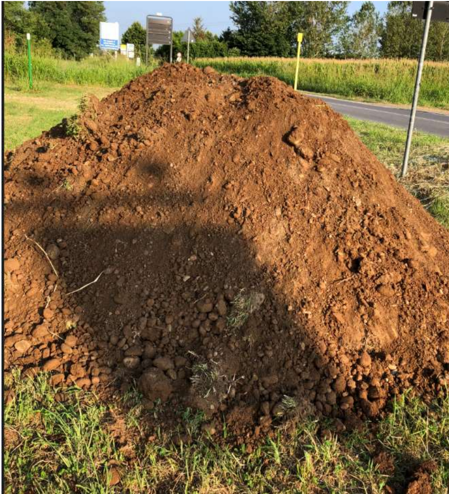
Figura 14 – Cumulo di sabbia limosa proveniente da scavo
