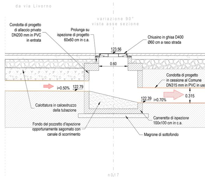
Particolare costruttivo: pozzetto d'allaccio P1
